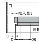
请在门与侧板之间留出尺寸为C的间隙。只要将本体端面与侧板端面对齐，即可方便地进行安装。
