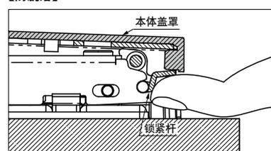
本体盖罩可锁定J95本体的锁紧杆, 防止因错误操作而造成门脱落。
