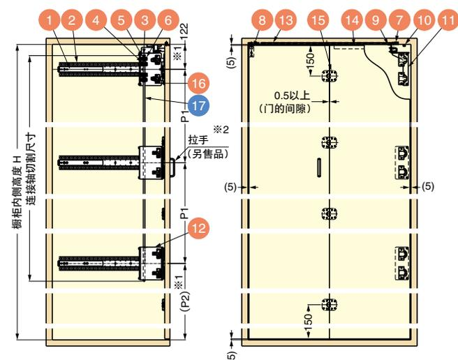
※1: 轨道①的安装位置, 需预先考虑门的垂下量※1尺寸。本图将各轨道①的安装位置提高了3mm。
