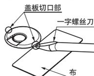
拆卸盖板时，请将一字螺丝刀插入两侧的盖板切口部。
