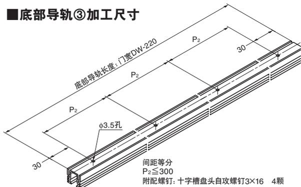
根据上图的尺寸切割底部导轨③，确保φ3.5mm孔的间距在300mm以下。
