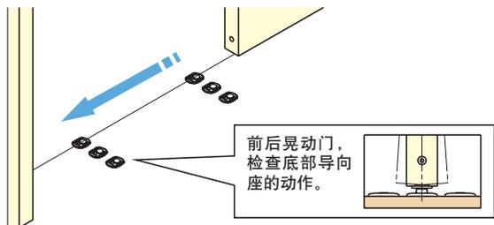
若底部导向销①未正确导入，或操作时门蜿蜒移动，请使用调节扳手④或专用工具（选配件），调节底部导向销①本体的方向。
