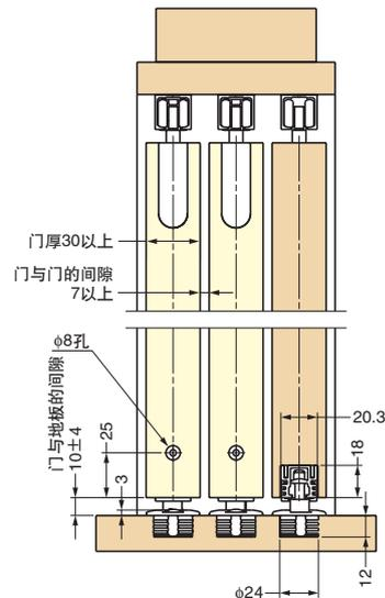
■门加工尺寸 (磁性导向座支承②、底部导轨③安装用)
