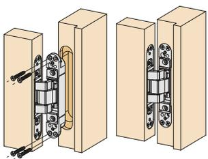
**ES -** Monte la puerta sobre el pilar, introduciendo la parte marco de las bisagras (profundidad 29,5 mm) en las ranuras correspondientes, luego fjelas enroscando los tornillos específicos.
