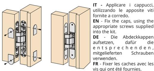
IT - Applicare i cappucci, utilizzando le apposite viti fornite a corredo.
