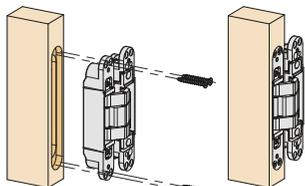
**ES -** Introduzca la parte de las bisagras marcadas "door" (profundidad 35,5 mm) en las ranuras de la puerta, eligiendo con atención el correcto sentido de apertura, luego fjelas enroscando los específicos tornillos.
