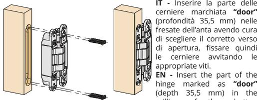
IT - Inserire la parte delle cerniere marchiata "door" (profondità 35,5 mm) nelle fresse dell'anta avendo cura di scegliere il corretto verso di apertura, fissare quindi le cerniere avvitando le appropriate viti.
