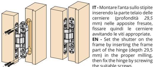
IT - Montare l'anta sullo stipite inserendo la parte telaio delle cerniere (profondità 29,5 mm) nelle apposite fresse, fissare quindi le cerniere avvitando le viti appropriate.
