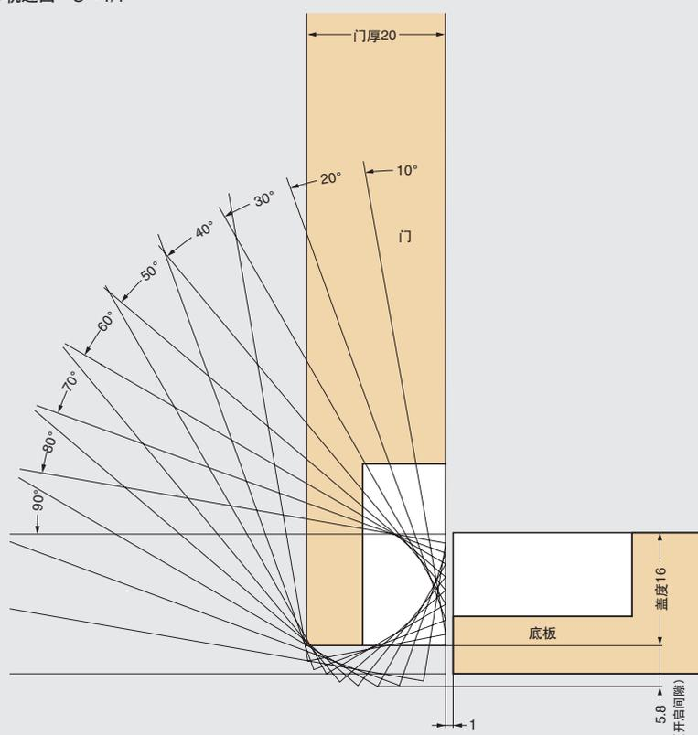
要进行门的开闭,必须留出开启间隙大小的缝隙。本图所示为门厚20mm、底板厚20mm、盖度16mm的规格。门厚改变后,开启间隙的数值会发生变化。请根据轨迹图进行确认。
