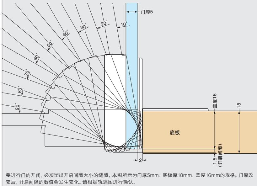
要进行门的开闭，必须留出开启间隙大小的缝隙。本图所示为门厚5mm、底板厚18mm、盖度16mm的规格。门厚改变后，开启间隙的数值会发生变化。请根据轨迹图进行确认。
