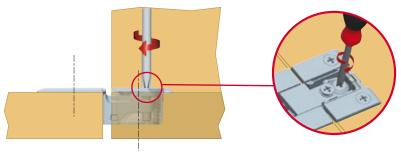
COVER CAP INSERTING COVER CAP UNINSERTING
